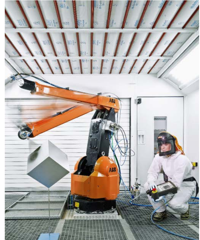
Robot de vaporisation pour l'application de nanorevêtements à l'INM
